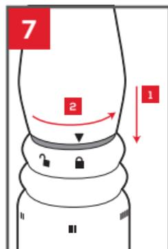
Réglage de la mouture / Adjusting the grind /
