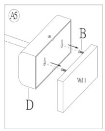
Accrocher le pied du luminaire (D) sur les vis de montage (B) et pousser pur verrouiller la base du lumunaire (D).
