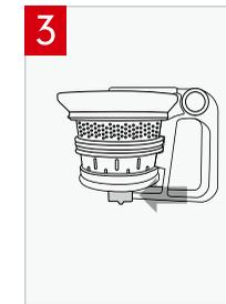
Faites glisser la languette de verrouillage vers le bout de la base jusqu'à ce qu'il se verrouille fermement en position.
