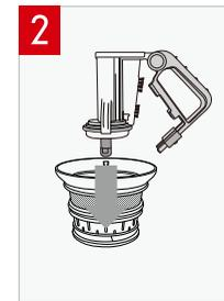
Insérez la base de l'outil de nettoyage dans la passoire, en vous assurant que le bout de la base est entièrement inséré à travers l'anneau en silicone. Pliez la poignée.
