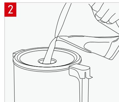
2 Versez l'eau à travers l'ouverture de la trémie automatique et laissez l'extracteur de jus fonctionner pendant 30 secondes.
