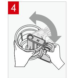
Sous l'eau courante, nettoyez en faisant tourner la brosse d'un côté à l'autre dans des directions opposées.
