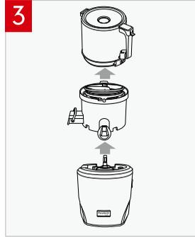
Soulever la trémie automatique et la chambre d'extraction l'un après l'autre et les séparer de la base.
