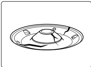
Le caoutchouc du capteur est brisé. Le capteur est inopérant.
