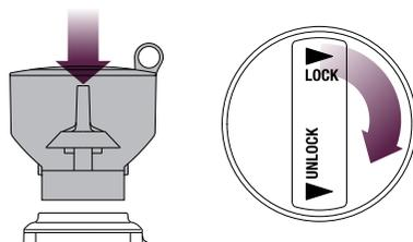
Pour retirer la trémie, tournez le cadran en sens antihoraire et soulevez-la. Le système de verrouillage assure un retrait et un transfert sécuritaire des grains dans un contenant.
