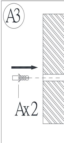
Insérer les ancrages en plastique (A) dans les deux trous dans le mur.
