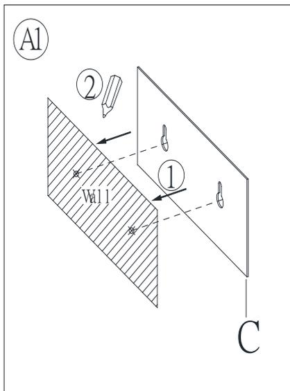
Déterminer l'endroit désiré du luminaire et placer temporairement le carton (C) sur le mur, marquer les 2 endroits sur le carton (C) sur le mur avec un crayon, puis retirer le carton (C) du mur marqué.
