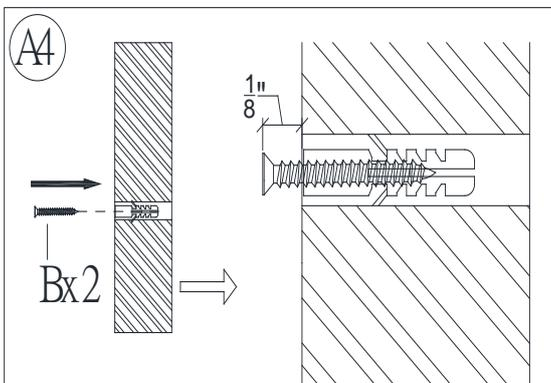
Insérer les vis de montage (B) dans les ancrages plastiques (A) dans le mur. S'assurer que la tête de vis et les fils 1/8 po sont en dehors du mur.
