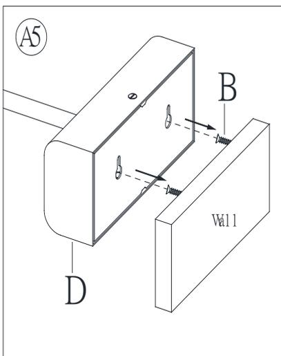
Accrocher le pied du luminaire (D) sur les vis de montage (B) et pousser pour verrouiller la base du luminaire (D).
