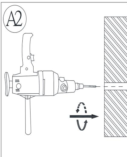
À l'aide d'une perceuse équipée d'une mèche de taille appropriée (juste assez grand pour faire un trou qui permet le passage des assemblages d'ancrages en plastique (A)), percer un trou au plafond à chacun des deux endroits marqués pour les ancres en plastique (A).
