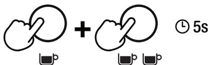
6. Appuyez et maintenez les touches 1 TASSE et 2 TASSES durant 5 secondes pour passer au mode cycle de nettoyage.
