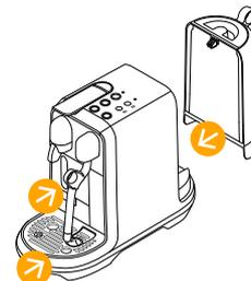
**Installer le réservoir d'eau**, insérer le bac d'égouttage et le compartiment à capsules. Pour plus de sécurité, utiliser la machine avec le bac d'égouttage et le compartiment à capsules en place.
