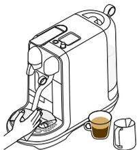
**Dès que le moussage** est terminé, soulever la buse vapeur et l'essuyer avec un chiffon propre et humide.
