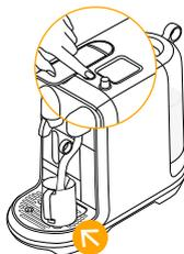
**Soulever la buse vapeur** et la positionner au centre du pichet. Presser la touche MARCHE/ARRÊT pour amorcer le moussage.
