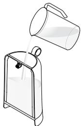
**Remplir le réservoir** avec de l'eau potable.
