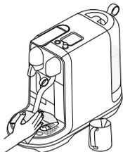
**Une fois le moussage** terminé, soulever la buse vapeur et l'essuyer avec un chiffon propre et humide.
