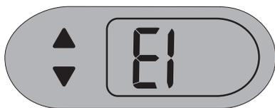
Le Batteur sur socle est équipé d'un interrupteur électronique de sécurité qui s'activera automatiquement si le moteur cale ou est surchargé. Cela se produit si trop d'ingrédients sont mélangés à la fois.
