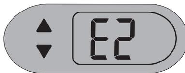
Le Batteur est équipé d'un dispositif de réenclenchement automatique qui le protège contre la surchauffe du moteur due à des charges excessives. Si une surchauffe survient, le Batteur activera automatiquement le dispositif de protection contre la surchauffe et le moteur s'éteindra immédiatement. Si cette erreur survient, tournez le cadran régulateur de vitesse en position d'arrêt (OFF) et débranchez l'appareil. Attendez au moins 15 minutes avant de redémarrer le Batteur.
